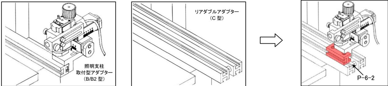
☆パッチクランプ用液圧マイクロマニピュレーターの取り付けには、ダブルアダプター(C型)を推奨しています。照明支柱取付型(B/B2型)のアダプターを所有していても、溝の向きが違うためにそのままでは取り付けはできません。また、顕微鏡によっては既製のダブルアダプターがない場合もあります。このような場合には、照明支柱取付型アダプター(B/B2型)と P-6-2 を組み合わせて使用することでマニピュレーターの設置ができるようになります。(安定性を重視される場合は、リアダブルアダプター(C型)への取り付けをお勧めします。)
